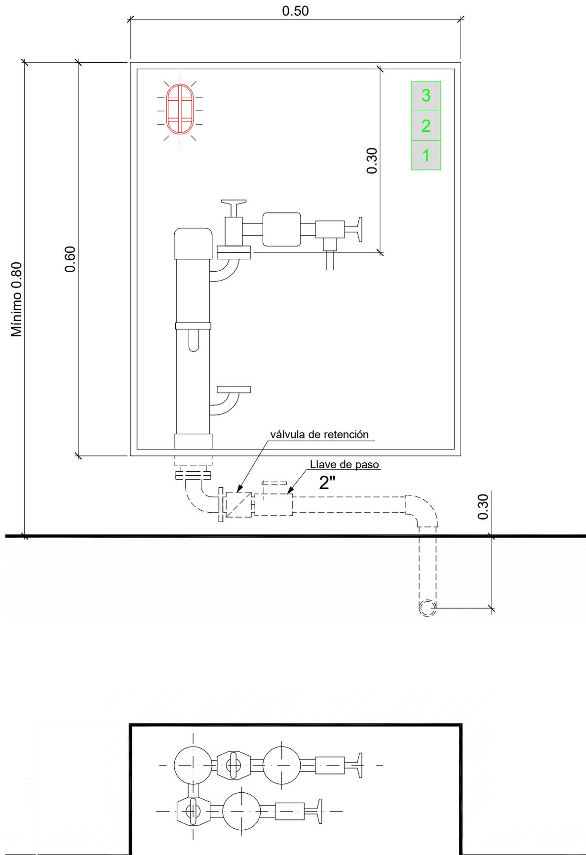
La habitación o armario tendrá el desagüe correspondiente, luz eléctrica, la placa de clasificación estará numerada con pintura o gravada, nunca con rotulador del tipo que sea, y la puerta siempre tendrá la cerradura de la compañía.
